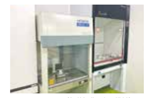
クリーンベンチ(無菌操作を行う機械)
